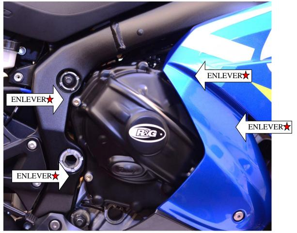
Le kit doit contenir : 1x Protection carter moteur (ECC0231R) 4x M6 x 40mm Boulons 4x Entretoises (S0820) 4x M6 Rondelles 1x Palet de course (SK0001SK (Déjà monté)). 2x Ecrous PAL (Déjà monté).
